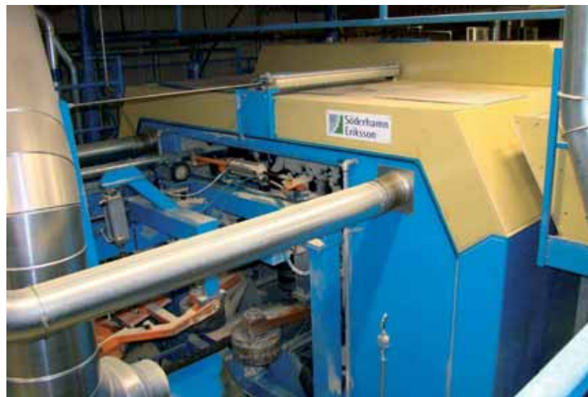
Рис. 5. Защитное ограждение ленточнопильного станка с системой вентиляции
