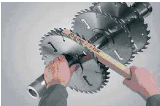
Рис. 2. Установка пил с помощью устройства Quickfix
