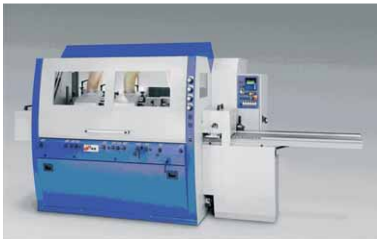
Рис. 4. Станок четырехсторонний Unimat Profi
