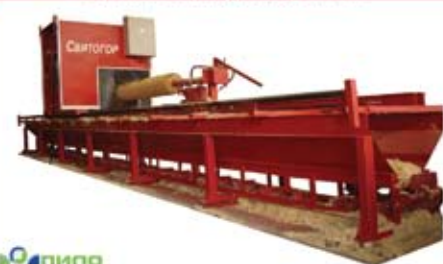
Станок для производства оцилиндрованного бревна и фигурной резьбы
