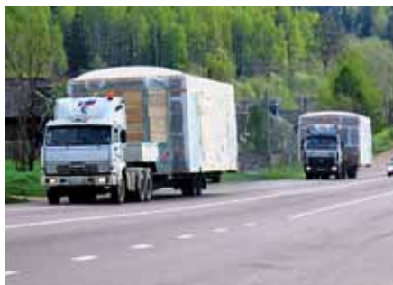
■ Перевозка модулей автомобильным транспортом
